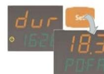
Pritisnuti SET taster ponovo za prikaz najviše temperature izmjerene sondom nakon što je instrument isključen i pre nego što je ponovo uključen, ukoliko je zadata granica temperature premašena.
